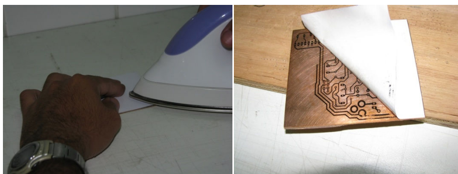
Figura 20 - Transferência térmica e remoção do papel
