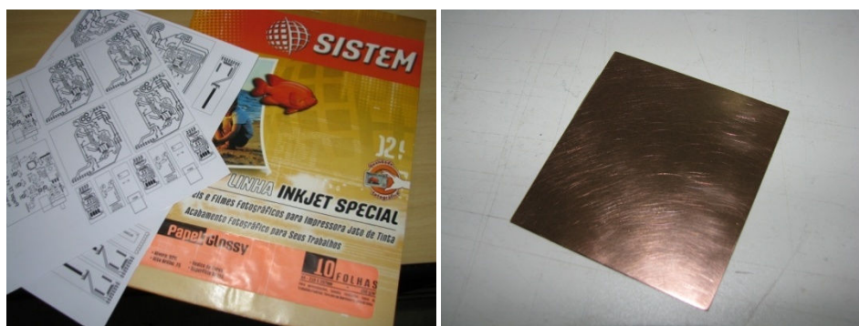
Figura 19 - Matriz do circuito e placa cobreada
